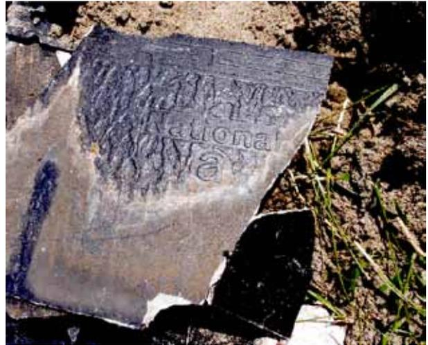
写真8:がれき仮置き場のアスベスト含有建材(2011.6.16)
