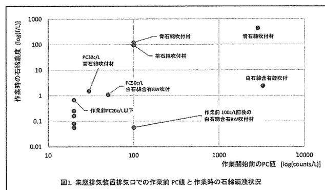
図1. 集塵排気装置排気口での作業前PC値と作業時の石綿濃度状況
